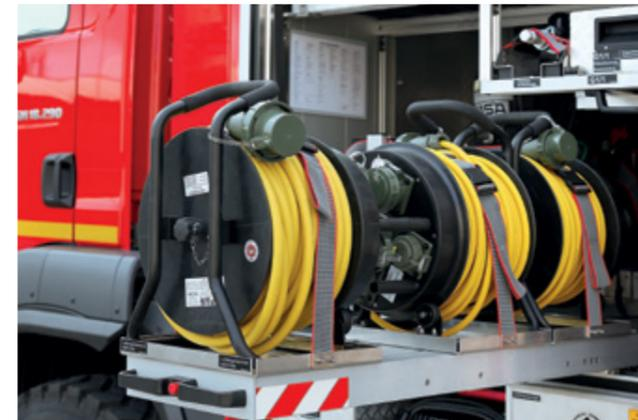
■ **LEITUNGSTROMMEL:** Per Teleskopauszug lassen sich die Leitungstrommeln mit 400 V / 16 A entnehmen.
