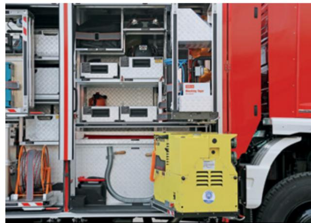
■ **STROMERZEUGER:** Ergonomisch auf Schwenklagerung verlastet.
