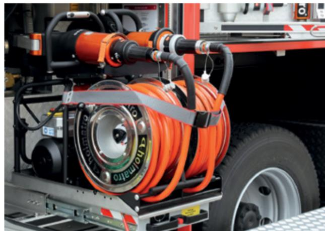
■ **LEICHTE ENTNAHME:** Hydraulische Rettungsgeräte sind ergonomisch im Tiefbau verlastet.
