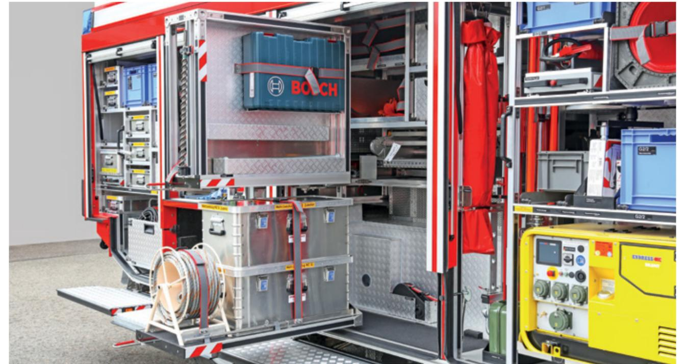
■ **KOMFORTABEL:** Ausschwenkbar in zwei voreingestellte Positionen – so lassen sich die Mehrzweckkästen, Werkzeuge und der Mehrzweckzug Z32 leicht entnehmen.
