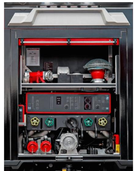
Übersichtlicher und ergonomisch optimierter **Pumpenbedienstand**
