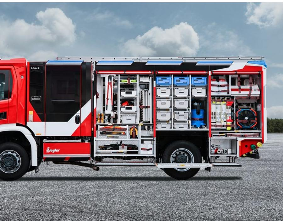
Noch mehr Raum für Beladung steht aufgrund des flexiblen ALPAS Aufbaus der neuesten Generation zur Verfügung.
