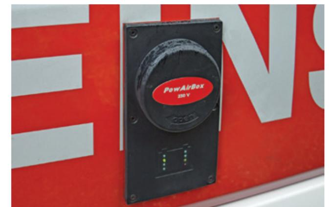
■ **POWAIRBOX:** Kombinierte Strom- und Druckluftversorgung mit automatischem Auswurf. Einspeisung von 230 V möglich.
