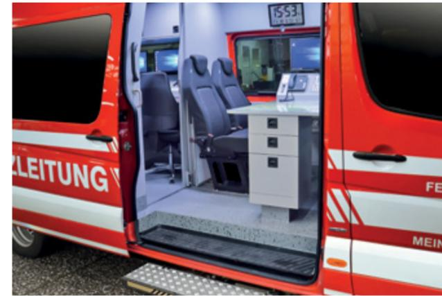
■ **DIGITAL:** Kommunikation ist alles – neueste Funk- und Telekommunikationstechnik bietet den Einsatzkräften Unterstützung, damit der Einsatz schnell abgearbeitet werden kann. Ausgestattet mit u. a. neuestem Digitalfunk, sowie die Ausrüstung mit 2 Meter- sowie 4 Meter-Vierkanalfunk, 2 Einsatzleitplätzen mit Datenanbindung zur Leitstelle garantieren optimale Kommunikation zwischen den einzelnen Einsatzkräften. Schnelle Organisation – schneller Einsatzerfolg.
