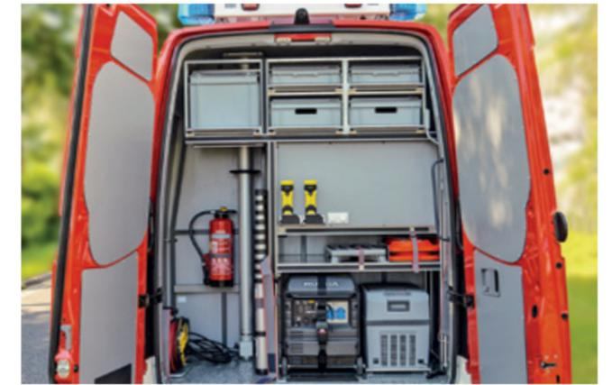
■ **ALLES GRIFFBEREIT:** Ergonomisch verlastete Beladung im Fahrzeugheck – garantiert eine schnelle und sichere Entnahme.
