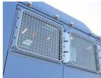
Zusätzliche Klappgitter vor den Scheiben erhöhen die Insassensicherheit.
