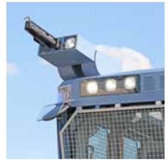
Die beiden fernbedienbaren Werfer auf dem Fahrerhausdach sind jeweils mit Kameras und leistungsstarken Scheinwerfern ausgestattet.
