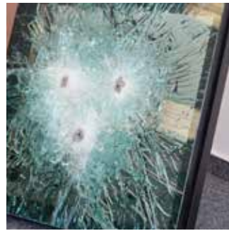
Die Scheiben der Sicherheitskabine sind schusshemmend ausgeführt.
