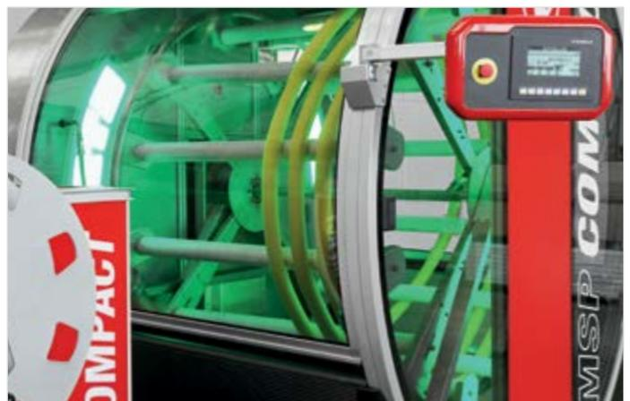
Um den Schlauch zu trocknen, wird er permanent mit warmem Wasser durchströmt. Durch die im Wasser gespeicherte Energie verdampft die Feuchtigkeit an der Schlauchoberfläche. Während des Trocknungsvorganges leuchtet grünes LED-Licht.
