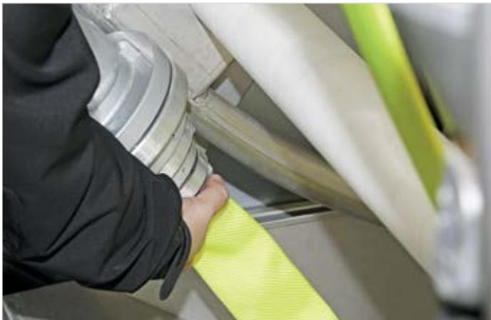
Um den Prüf- und Trocknungsprozess vorzubereiten, wird der Schlauch an die Ladestation angekuppelt.
