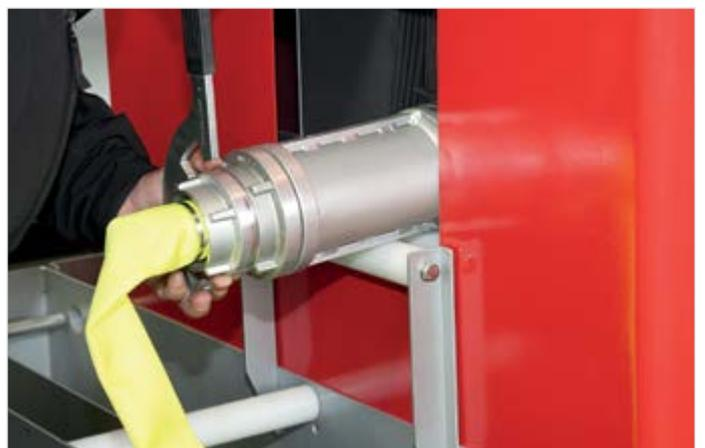
Ein Fangadapter wird mit Hilfe eines Kupplungsschlüssels an den zu waschenden Schlauch angegekuppelt und zieht diesen in das Waschmodul der Anlage.
