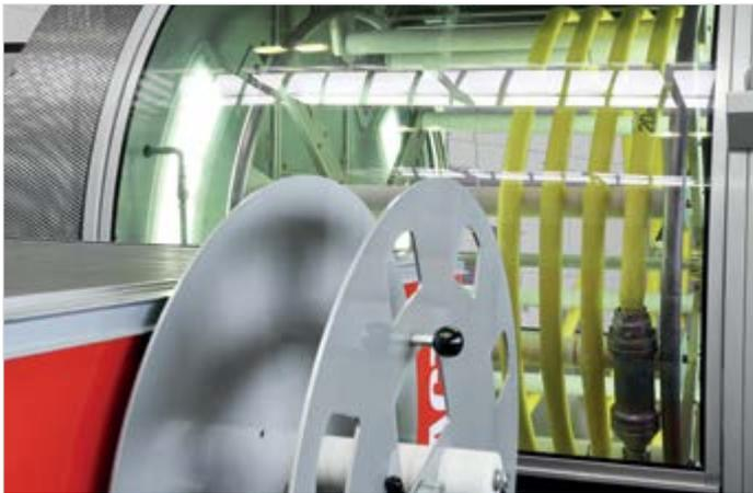
Nach dem Abschluss des Außentrocknungs-Verfahrens beginnt die Innenreinigung und -trocknung mit dem Reinigungsmolch. Das Licht wechselt auf Gelbgrün.
