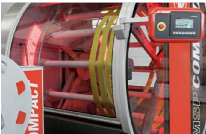
Mit dem Start des Arbeitsganges „Prüfen“ – erkennbar am hinterlegten roten LED-Licht – füllt sich der Schlauch mit Wasser. Die spiralförmige Wicklung ermöglicht eine Sichtprüfung. Mit dem Prüfvorgang beginnt bereits das Trocknen.
