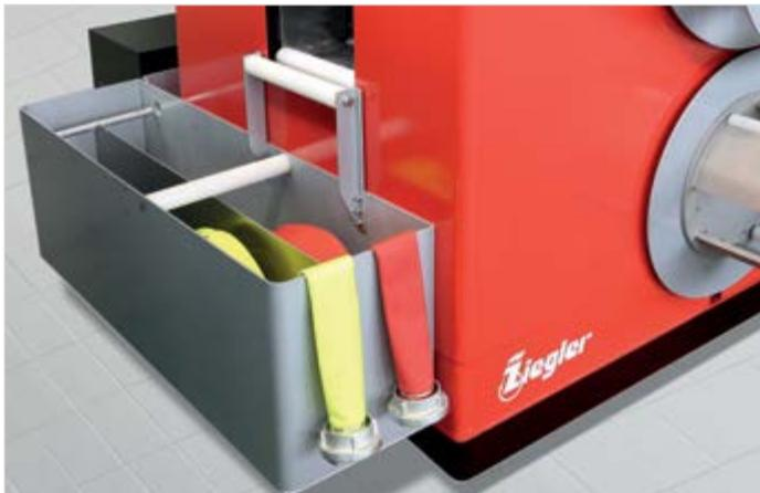
Die gebrauchten und verschmutzten Schläuche werden in einem speziellen Behälter eingeweicht.
