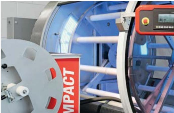
Start des Waschvorganges: Der Schlauch wird automatisch unter Bürsten und Hochdruck gereinigt. Dieser Arbeitsgang ist mit blauem LED-Licht hinterlegt.
