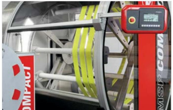
Vor dem Start des Prüfvorganges ist der Schlauch auf der Prüftrommel aufgewickelt.
