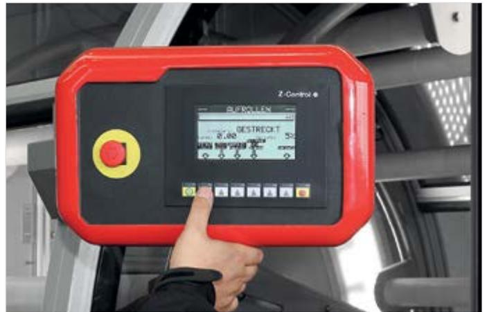
Am Bedientableau erfolgt die Auswahl des Modus für das einfache oder doppelte Wickeln des fertigen Schlauches.
