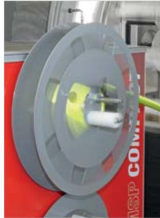
Im Anschluss erfolgt die vollautomatische Aufwicklung wie gewünscht.
