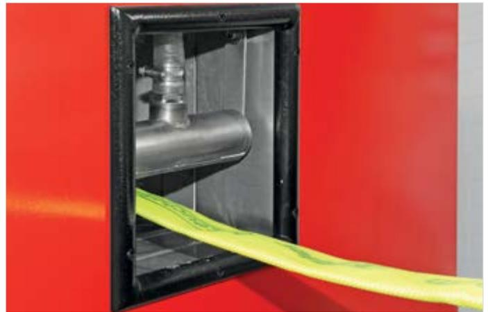
Parallel zum Waschprozess wird der gewaschene Schlauch mit Luft vorgetrocknet, indem die Feuchtigkeit vom Schlauch abgeblasen wird.
