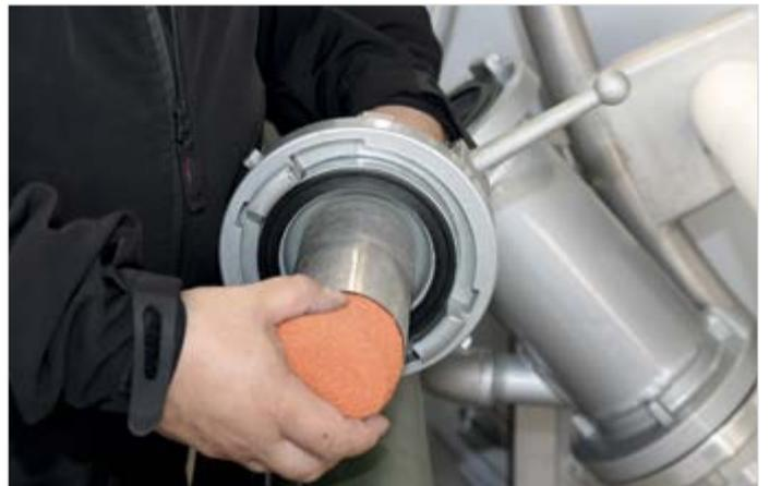
Zur Innentrocknung und Reinigung der Schläuche wird die Maschine mit einem Reinigungsmolch bestückt.
