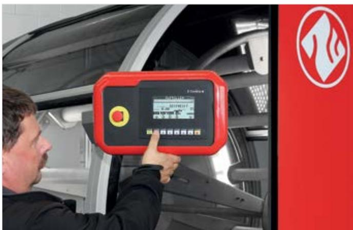
Alle Arbeitsgänge der Maschine werden über das Bedientableau eingeleitet.
