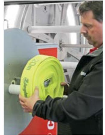
Der gerollte Schlauch: schnell gereinigt, geprüft, sauber, trocken und einsatzbereit bzw. lagerfähig.
