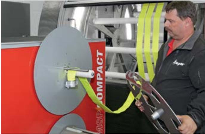
Zur Vorbereitung der Schlauchaufwicklung wird der Schlauch in den Wickler eingehängt und die Wicklerscheibe zur Sicherung aufgesetzt.
