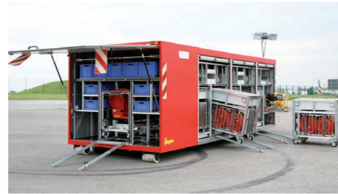
Abrollbehälter (AB) Hochhausbrand mit 11 Rollcontainern, Tragkraftspritze und vielfältiger Schlauchausrüstung
