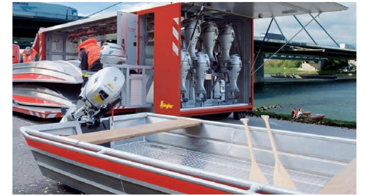
Transport und Lagerung von 10 Booten mit Außenbordmotor auf hydraulischen Schwenkwänden
