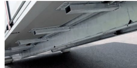
Diese Untersicht verdeutlicht die Längs- und Querträgertechnik – einschließlich der heckseitigen Rollen zum Bewegen des Behälters.
