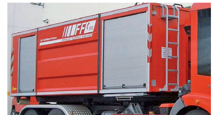
AB Wasser/Schaum in Modulbauweise mit 5000-l-Wassertank sowie 300-l-Schaummittel-tank einschließlich Werfer und Feuerlösch-Kreiselpumpe FPN 10-1500-A
