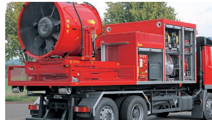
AB Mobiler Großlüfter mit Geräteräumen für zusätzliche fahrbare Hochleistungslüfter
