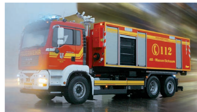
AB Wasser/Schaum mit innenliegendem 6000-l-Wassertank sowie 500-l-Schaummittel-tank, integrierter Pumpe FPN 10-3000-A, 1 FireDos 2500 und fernbedienbarem Wasser-/Schaumwerfer
