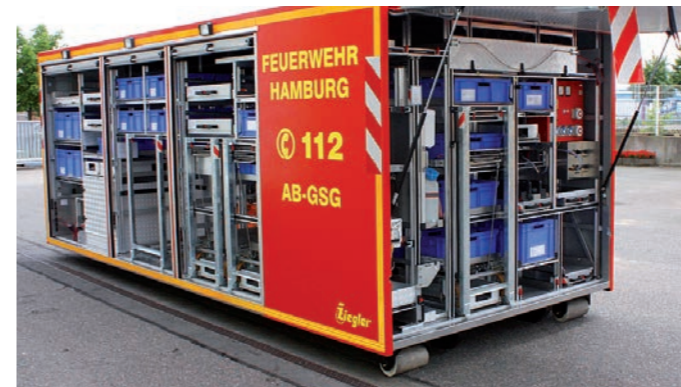
AB Gefahrgut mit umfassender Ausrüstung und Rollcontainern
