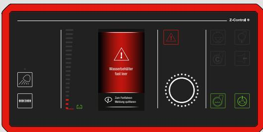
Assistenzsystem für Warnungen, Fehler und Statusanzeigen, Sicherheit durch Quittierungsfunktion und akustische Einsatzunterstützung
